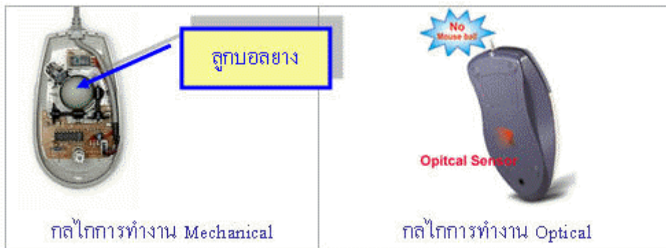
ภาพที่ ๖.๑๔ กลไกการทำงานของเมาส์
